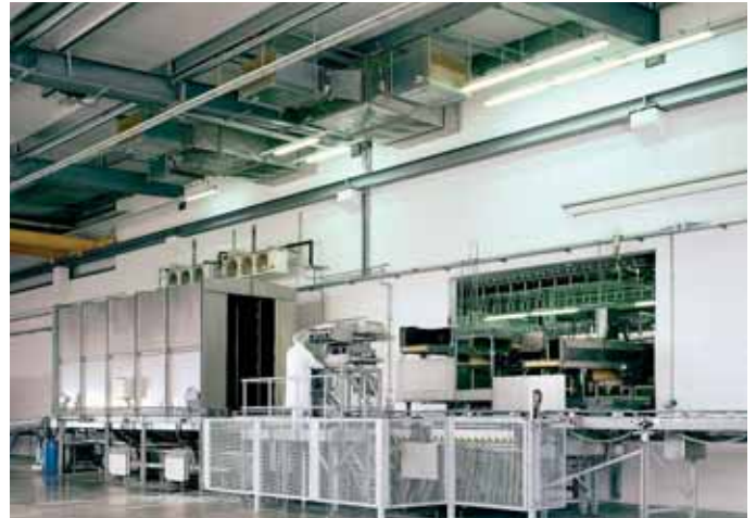
Vollautomatische Putenanlieferung mit CO 2 -Betäubung.
